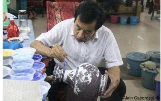
Les alvéoles obtenues vont être alors remplies d'**émail** grâce à un mélange de poudres d'argent, de cuivre et de borax avant de cuire à petit feu. Comme tous les colorants n'ont pas le même point de fusion, plusieurs cuissons sont nécessaires et l'on doit appliquer plusieurs couches de colorants pour obtenir l'effet désiré.
